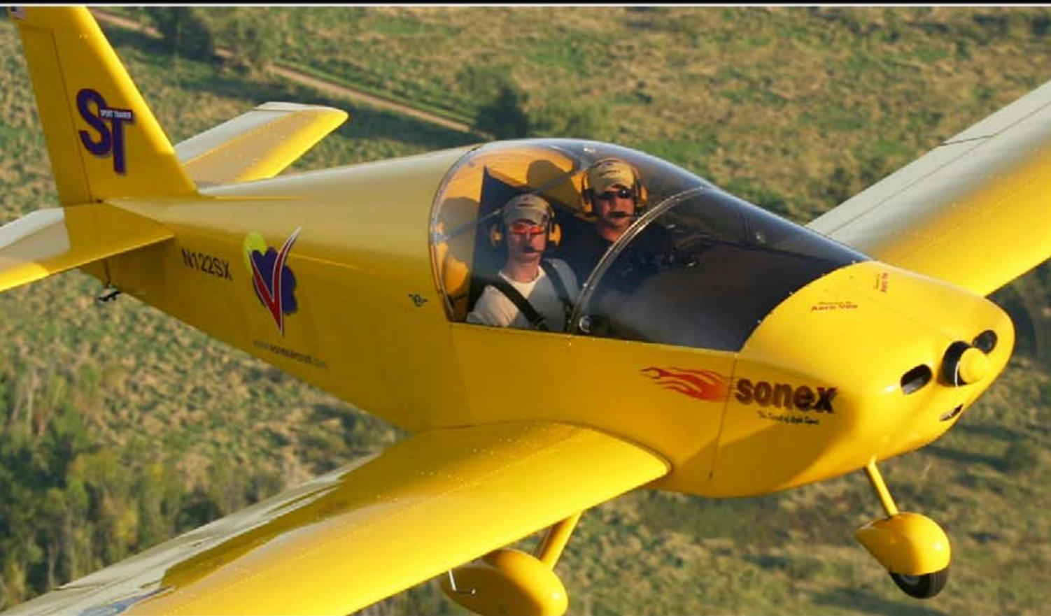
Sonex套材飞机公司致力于提供休闲娱乐飞行群体一个创新的、物有所值且高效实用的飞机套材、动力装置和附属配件。是一款设计简单且经济实用的两用金属制单翼飞机。设计被用来满足欧洲和本土市场对运动飞机的需求，飞机可承载80到120马力的多种轻重量当代引擎（引擎包装重量少于200磅），契合美国新轻型运动飞机/飞行员标准。
